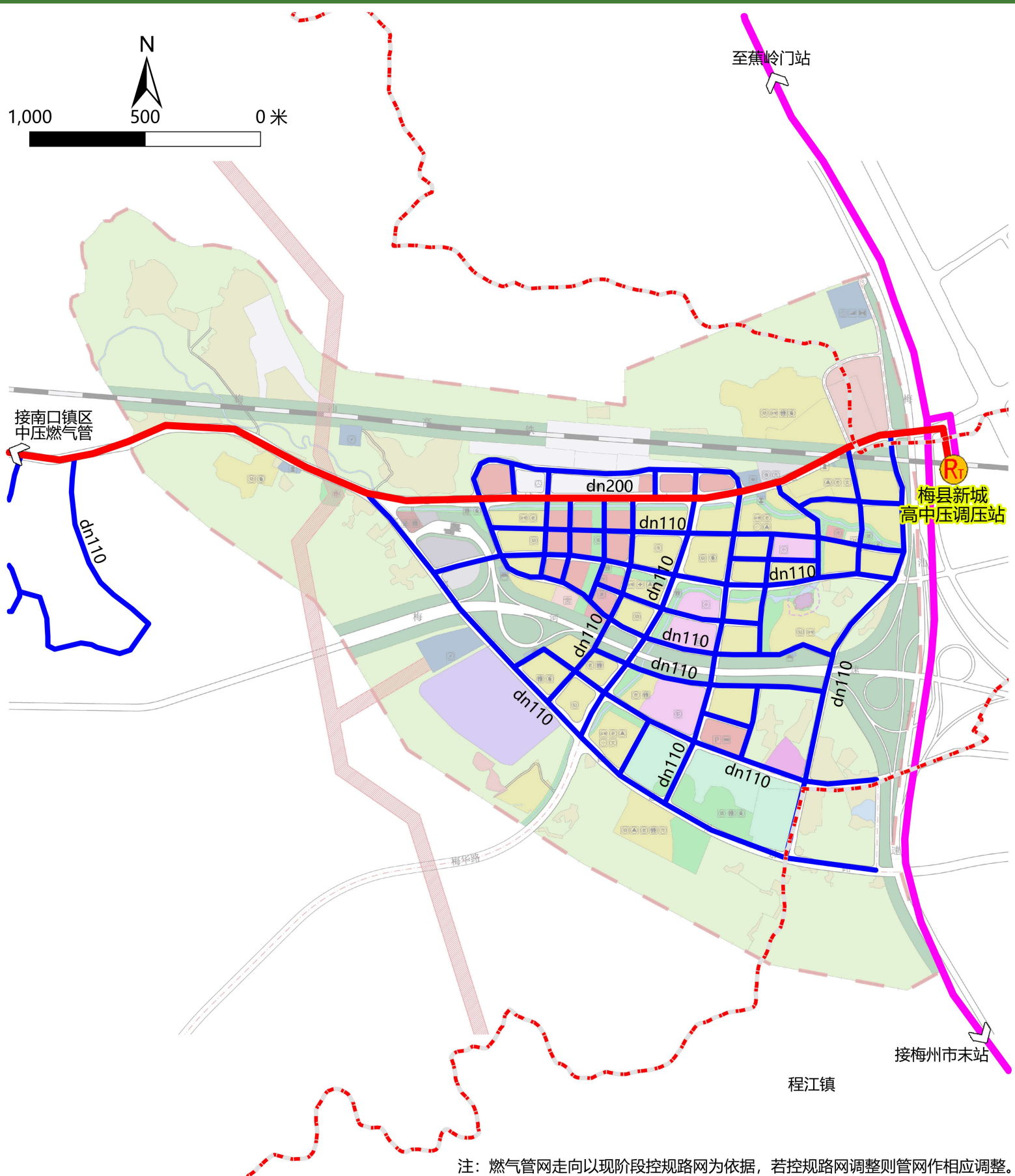
南口镇高铁片燃气管网布置图
