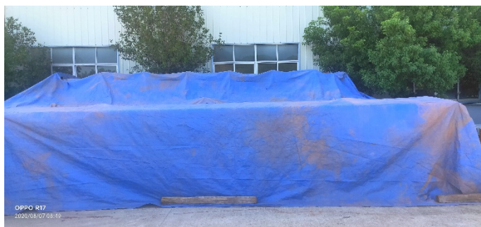
图3-12 成品露天堆放防护措施
