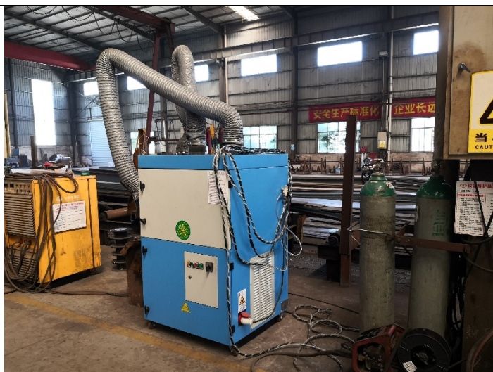
图3-3 移动式电焊废气处理装置
