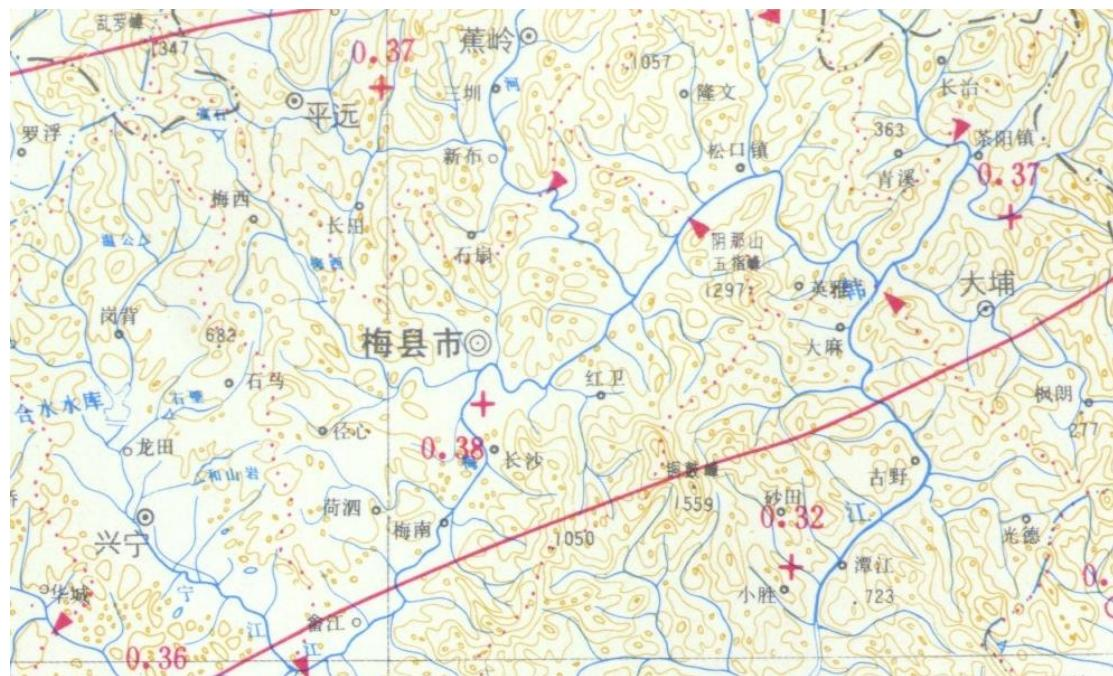
图 4-2 复垦区所在地 1956~1979 年年径流深变差系数 Cv 等值线图
