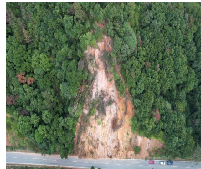
K34+250~K34+430 段路基左侧上边坡塌陷
