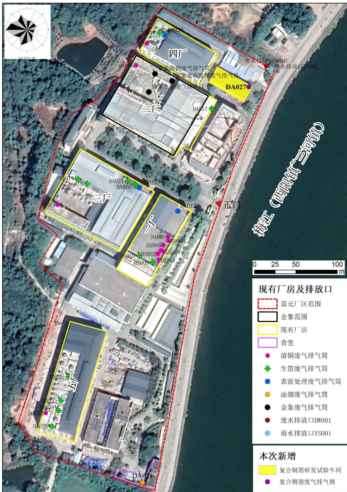
附图4 厂区废水、废气排放口分布图
