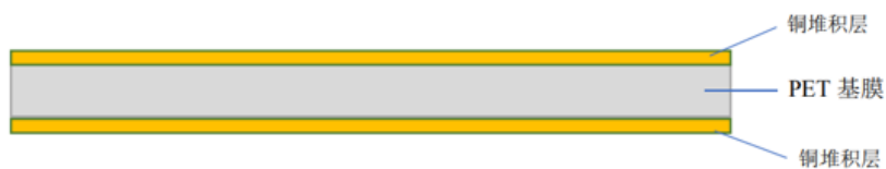
图2-1 PET 铜箔结构示意图
