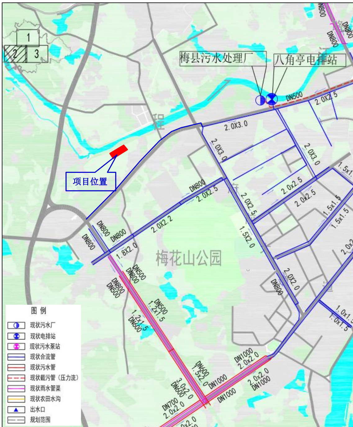
图 5.3-3 项目附近市政污水管网现状铺设图
