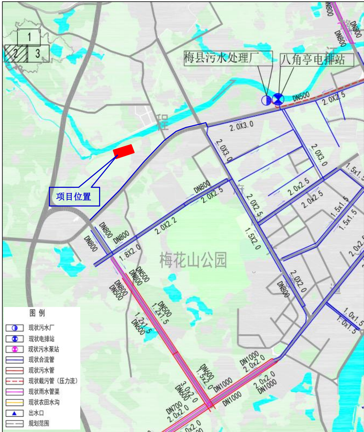
图 7.2-2 项目附近市政污水管网现状铺设图
