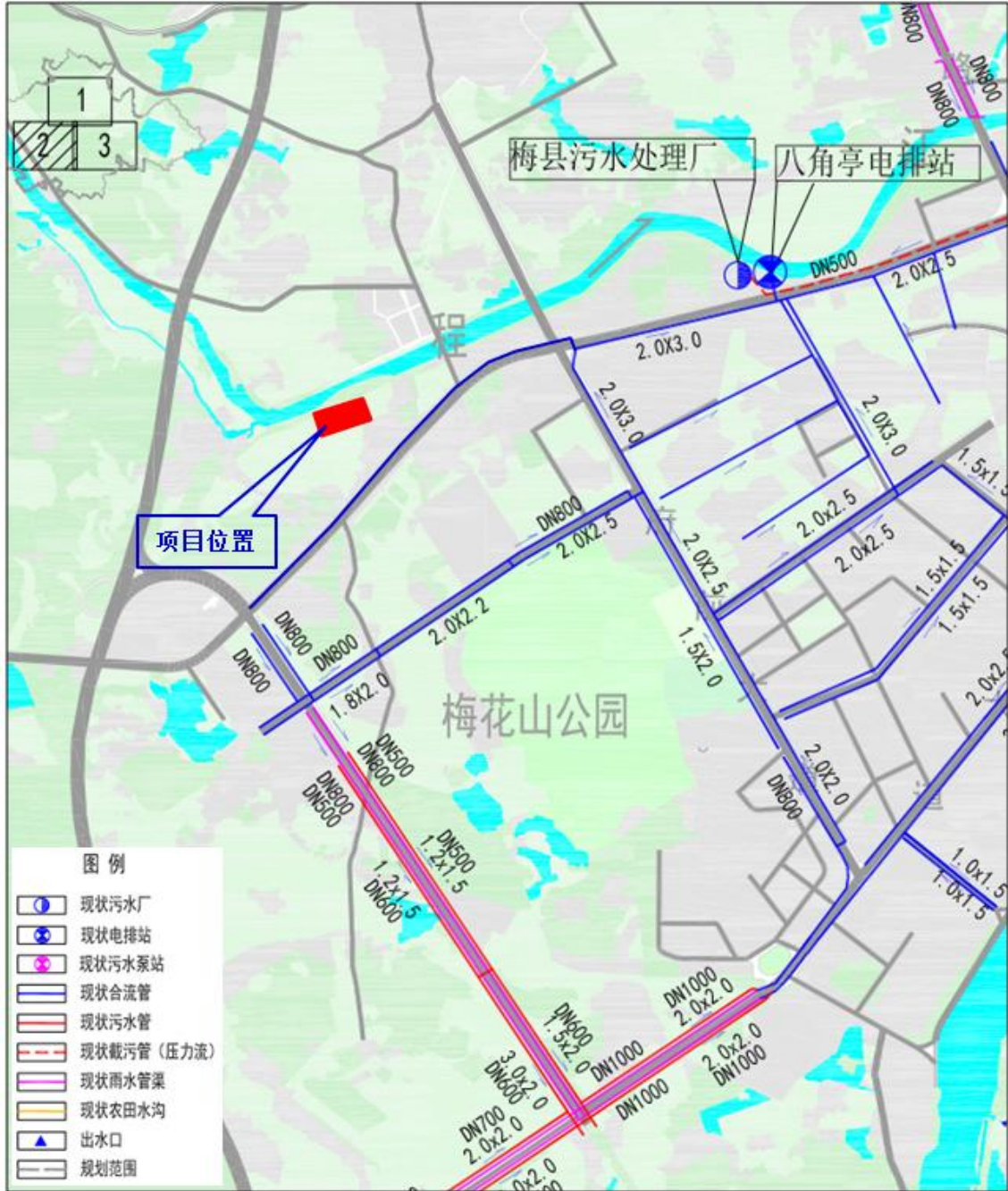
图 5.1-1 梅县新城水质净化厂现状污水管铺设网图
