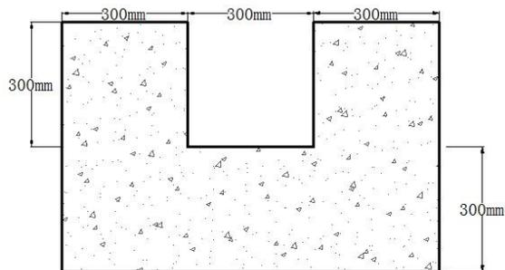
图 5-1 采场截排水沟断面示意图 图 5-2 矿山道路截水沟断面示意图
