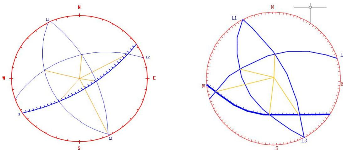
图 3-2 采场东面边坡 BP2 赤平投影图 图 3-3 采场南面边坡 BP3 赤平投影分析图
